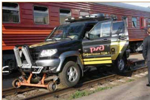
Дефектоскоп ЛДМ-1 на базе УАЗика
