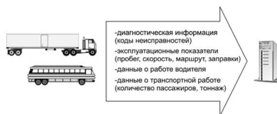
Рис. 2 Информационный поток в интегрированной в fleet management системе
